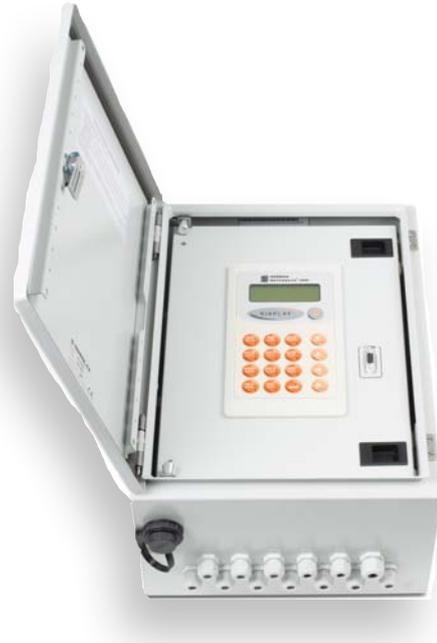
Tal flexibilidad de los puertos de comunicaciones, entradas y salidas y de la capacidad de memoria permite conectar el sistema a un gran número de distintos sensores, como anemómetros, visibilímetros, pluviómetros, etc., además de procesadores de ruido o cámaras digitales para adquisición y transmisión de imágenes.
